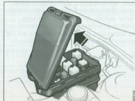
Vordere Elektrozentrale im Motorraum
